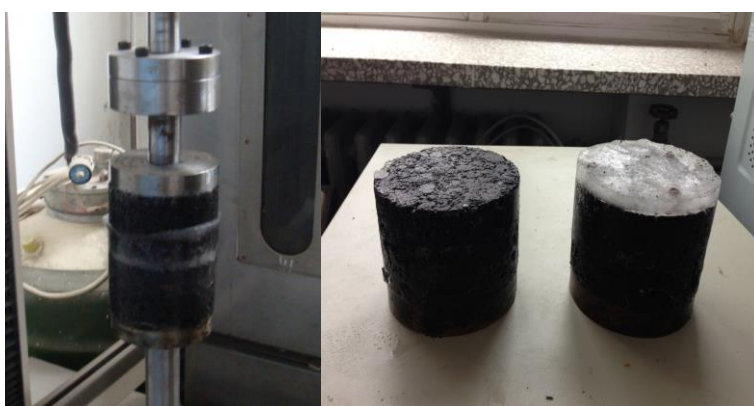
图 5 双试件拉拔试验方法
