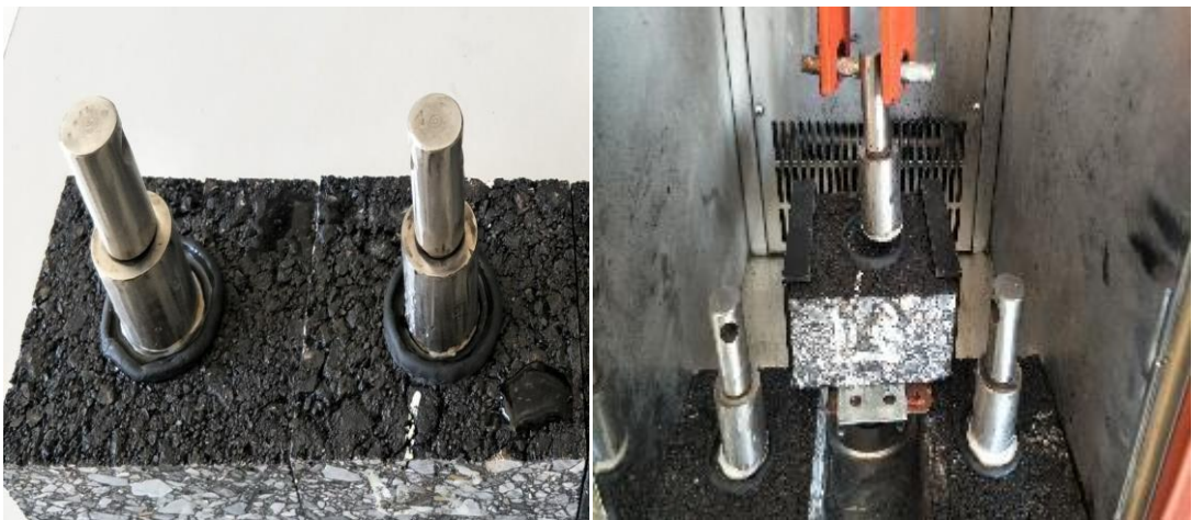
图 7 改进粘结强度确定冰点方法
